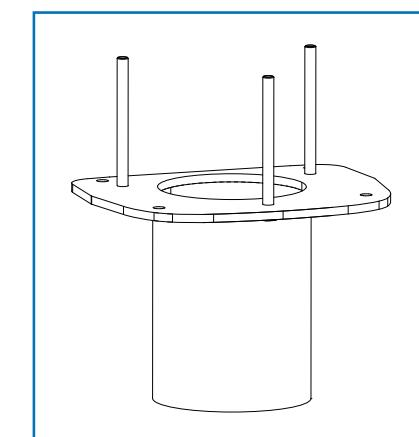
För infästning av adaptern behövs ett betongfundament med skruvförband, på vilket man kan spänna fast en stolpe med diametern 115 mm. Adaptorn ska fästas stadigt med betongfundamentets fästsprutor. Åtdragningsmomentet kan variera beroende på betongfundamentet.
