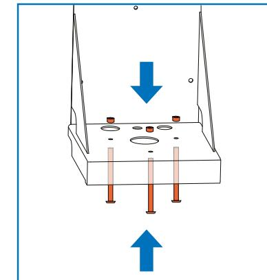
mot marken. Fästning sker genom fyra (4) hål med diameter på 9 mm i väggen. Fundamentet måste installeras vågrätt.
