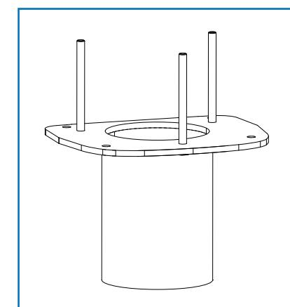
Adapteri vaatii kiinnitykseen ruuvikiristeisen betonijalustan, johon voidaan kiristää halkaisijaltaan 115 mm pylväs. Adapteri tulee kiinnittää betonijalustan kiinnitysruuveilla tukeasti kiinni. Kiristysmomentti voi vaihdella betonijalustojen mukaan.
