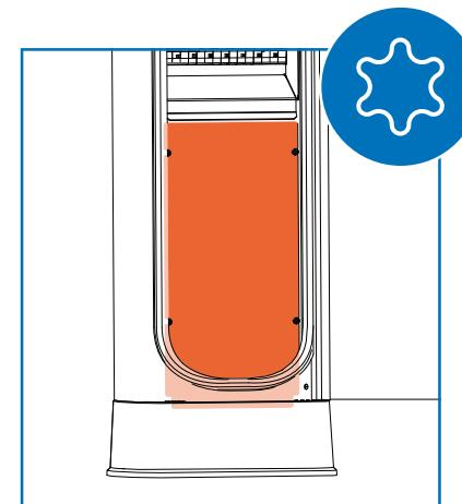
Lägg stationen liggande med baksidan mot marken så att dess botten ligger mot markfästena och matarkablarna. Obs. Skydda stationen innan den placeras liggande så att det inte uppstår bucklor och repor. Du kan till exempel använda förpackningsmaterialet som skydd.
