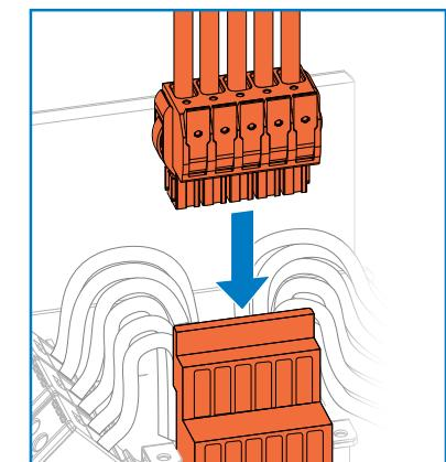
Släpp sedan stationsdelen på plats och rikta in kanten på dess beröringsskydd mot spåret i bottenskålen. Se till att stationsdelen kommer ordentligt på plats.
