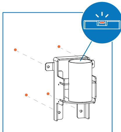
Komplettera installationen med täckprofilen. Täckprofilen fästs med fyra (4) Torx 20-skruvar (T20).
