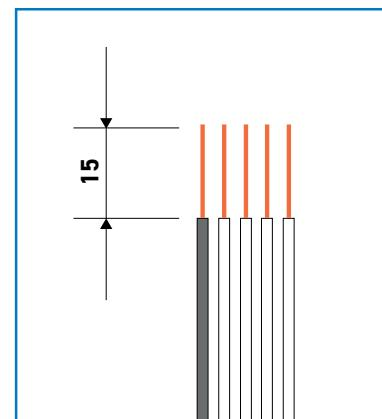
Suorita liitos. Syöttöliittimen kiristysmomentti 3 Nm (2,5...16 mm<sup>2</sup>) tai 6 Nm (2,5...35 mm<sup>2</sup>). Huolehdi, että johtimien lenkki ei nouse yli pohjakupin asennuspelin korkeuden, sillä runko lasketaan tähän korkeuteen ja johtimet saattavat jäädä puristuksiin.
